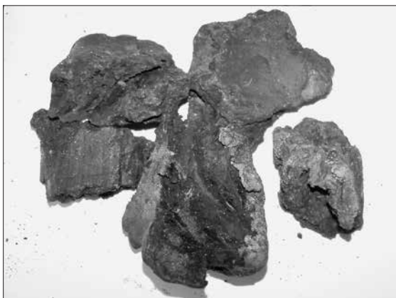
Fot. X.2. Węgiel brunatny z pokładu „Montania” w Pile. Próbką pozyskana przez Główny Instytut Górnictwa z Katowic w trakcie badań geologicznych w 2009 r.
