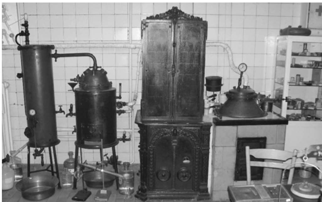
Zdj. 7. Fragment linii produkcyjnej napędzanej parą wodną – laboratorium galenowe w Muzeum Farmacji Apteki „Pod Łabędziem” w Bydgoszczy, fot. Wojciech Ślusarczyk
